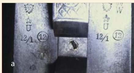
12. Казённая часть ствольного блока тройника Fr. Jäger & Co, Suhl i. Thüringen, изготовленного около 1912 г. Маркировка «Nitro с короной» выполнена не на нижней, а на боковой поверхности каждого ствола
