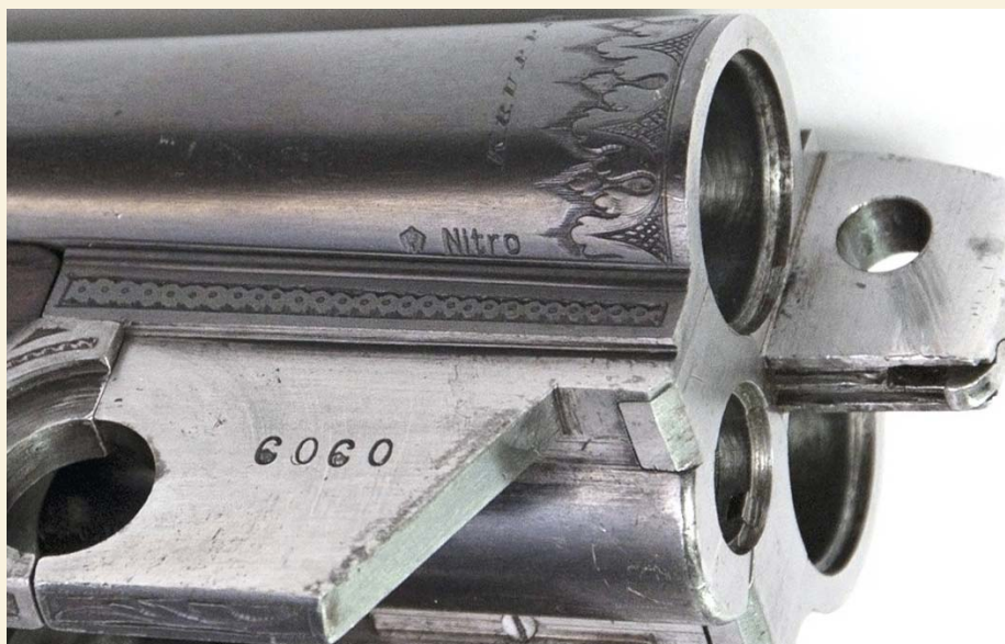
12. Казённая часть ствольного блока тройника Fr. Jäger & Co, Suhl i. Thüringen, изготовленного около 1912 г. Маркировка «Nitro с короной» выполнена не на нижней, а на боковой поверхности каждого ствола
